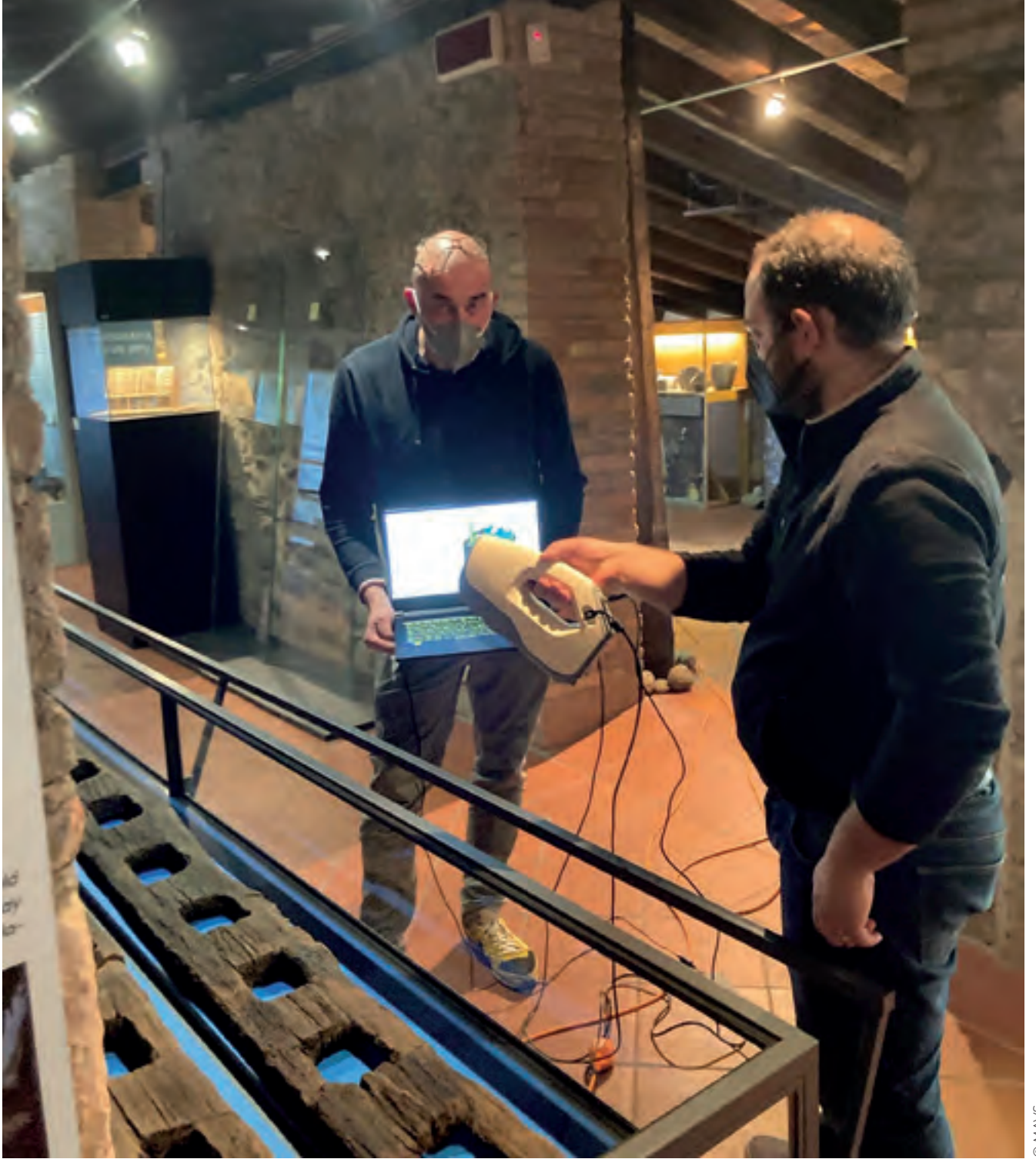
Documentazione 3D di una trave multiforata. 3D documentation of a multi-hole beam.
